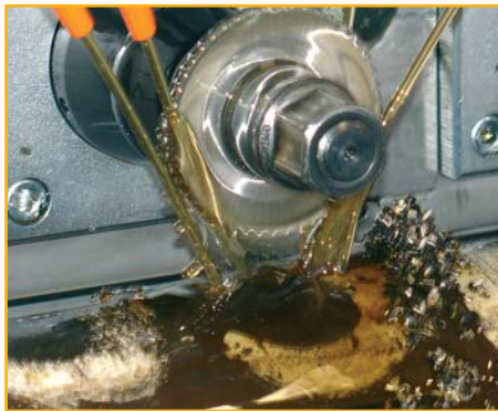
Afbeelding 4. Sleuvenfrezen in de praktijk. Bewegingen en veiligheidsfuncties worden aangestuurd en bewaakt via CANOpen.
