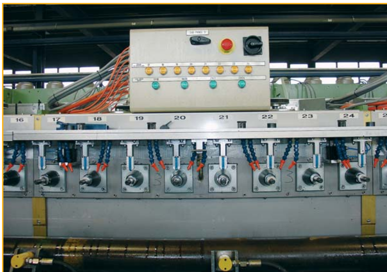
Afbeelding 2. De zestien meter lange machine beschikt over tien secties met elk acht freeskoppen.
