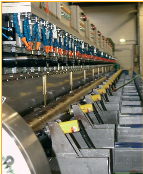
Afbeelding 2. De zestien meter lange machine beschikt over tien secties met elk acht freeskoppen.
