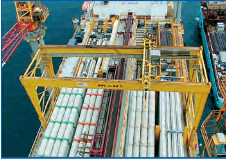
Antislingsysteem voor bovenloopkraan op het boorschip Deepwater Discovery, ontwikkeld door TEVEL.
